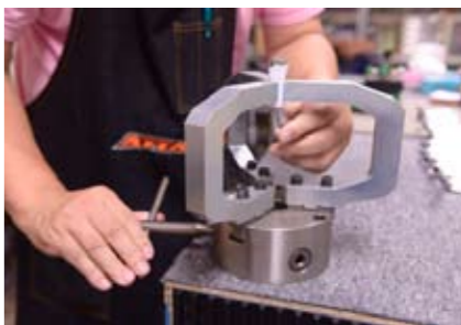
扶桑電機工業の社員が製作してくれた、クラブを固定するための治具。3方向から均一に力を加えるため、ホーゼル部分の中心がズレることなく固定できる
